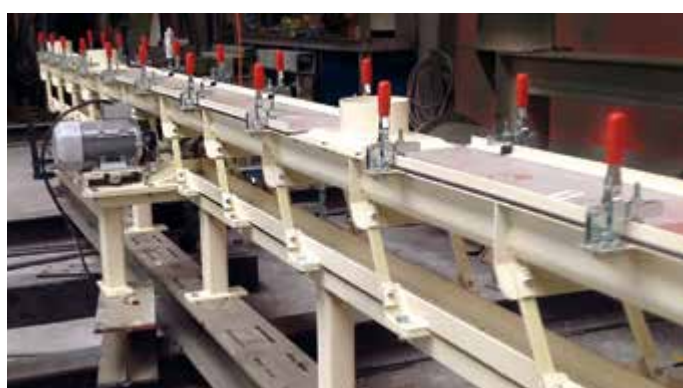
Convoyeur NFB avec ressorts de suspension en fibre de verre
