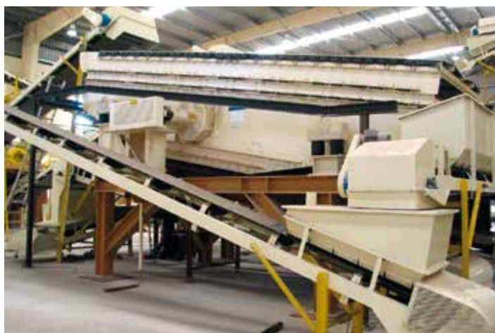
Crible à maille élastique BIVITEC de Binder + Co
