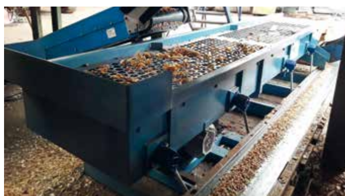
Convoyeur NFR avec articulations élastiques
